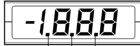
DP3 DP2 DP1
